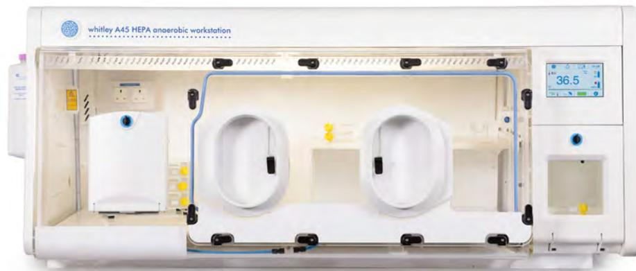
Die Whitley A45 Arbeitsstation ist 50% größer als eine A35 und verfügt über drei Handeingänge, die einen bequemen Zugriff auf den gesamten Inkubations- und Arbeitsbereich ermöglichen. Selbst bei relativ geringem Platzbedarf wird die Inkubationskapazität maximiert und die perfekte kontrollierte Umgebung für kleine oder große Probenzahlen geschaffen. 750 x 90 mm Petrischalen können untergebracht werden und man hat dennoch genug Arbeitsfläche.
