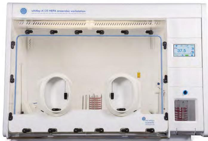
Die A135 ist ideal für Studien, bei denen eine Vielzahl von Geräten in einer anaeroben Umgebung verwendet werden muss. Diese Arbeitsstation wird mit zwei Gasversorgungen betrieben, um die kostengünstigsten Betriebsbedingungen zu erreichen. Die A135 wird Ethernet-fähig für den Fernzugriff auf den Touchscreen geliefert. Die eingebaute Schleuse sorgt dafür, dass Proben so schnell wie möglich in die Arbeitsumgebung gebracht werden können - dauert nur 60 Sekunden.
